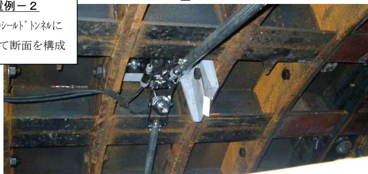
図1 ユニバーサル変位計の概略図
