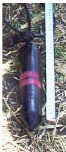
発振器 ( \phi 44\text{mm} , L=200\text{mm} )
