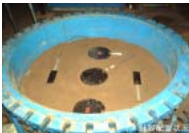
図1. 土圧計試験の土槽
