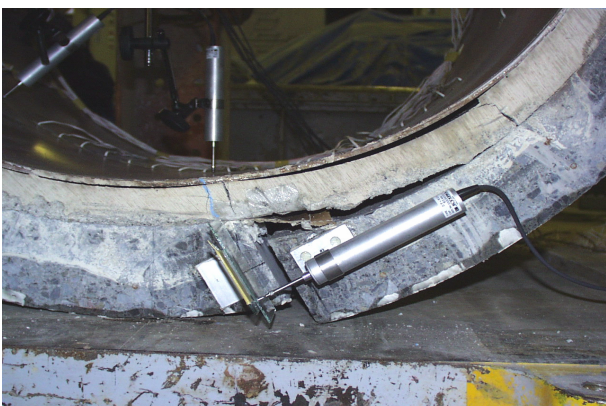
写真-2 鋼管セグメント大変形時の状況
