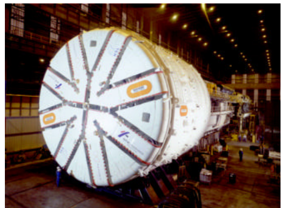
写真-1 シールドマシンの全景
