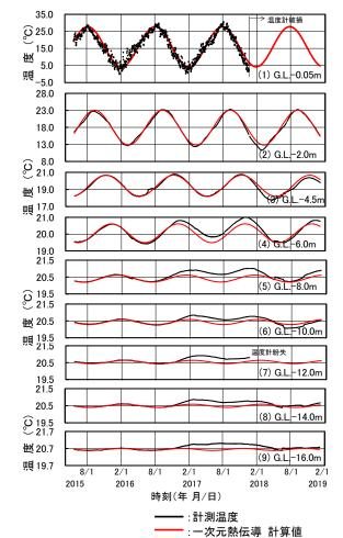
図-11 観測井 N3 深度毎地温のフィッティング結果
