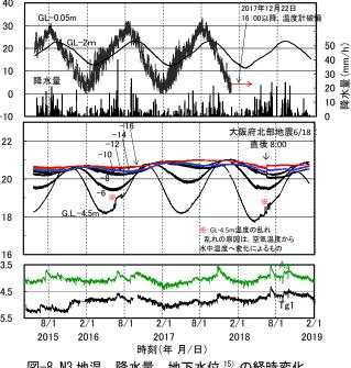
図-8 N3 地温, 降水量, 地下水位 15) の経時変化
