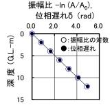
図-10 深度と振幅比の対数, 位相遅れの関係(図-9の計算例)
