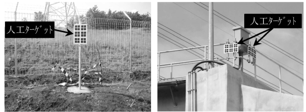
(a) 計測点(人工ターゲット) (b) 不動点(人工ターゲット) (ターゲットパネルの寸法: 300×400mm, t7mm)
