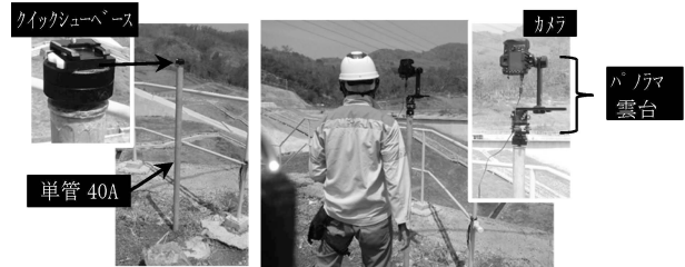
(c) カメラ設置架台 (d) 撮影状況
