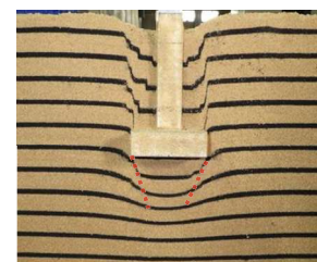
図-4 (b) 実験における地盤の変形状態
